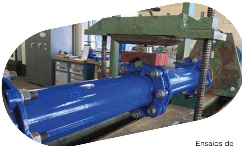
Ensaio de qualidade conforme NBR 7675 e ISO 2531.
