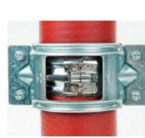
1. Posicione as duas partes da abraçadeira dentada para que elas prendam o tubo em paralelo. Certifique-se de que as janelas da abraçadeira não fiquem apoiadas no parafuso de vedação da junta e que os dentes não entrem em contato com o corpo da junta, para evitar qualquer risco de esmagamento;
