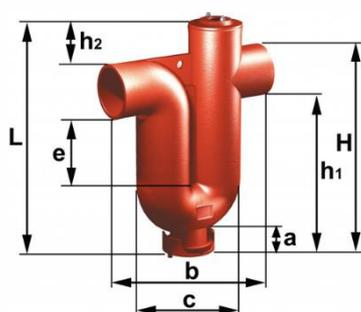
Presença de uma seta no corpo da peça que indica a direção do fluxo, bem como uma tampa de limpeza na base.
