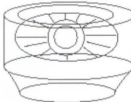
3º - Retirar o chapéu levantando uma das suas extremidades. Para a remontagem repetir os passos anteriores.
